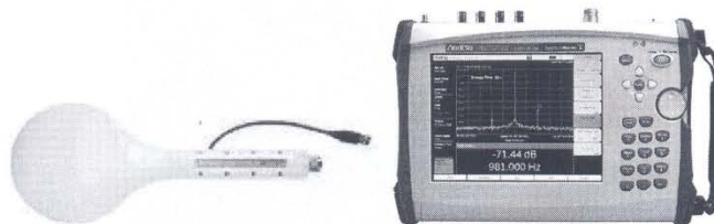
Fig1. Pajisjet e përdorura për monitorimin e rrezatimeve jojonizuese.
